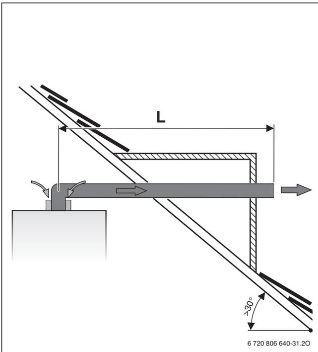
Рис. 6 Горизонтальный отвод дымовых газов  $V_{22}$
