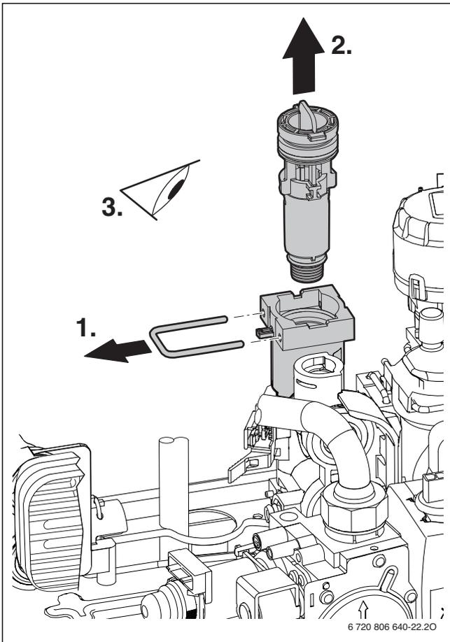
Рис. 37 Проверка фильтра в трубе холодной воды
