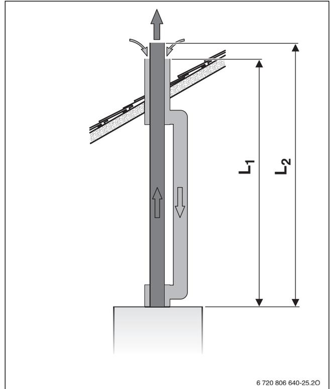
Рис. 11 Вертикальный отвод дымовых газов через отдельную трубу C<sub>32</sub>
