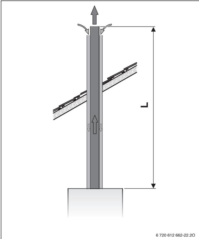
Рис. 10 Вертикальный отвод дымовых газов через концентрическую трубу C<sub>32</sub>
