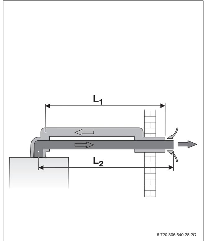
Рис. 9 Горизонтальный отвод дымовых газов через отдельную трубу C<sub>12</sub>
