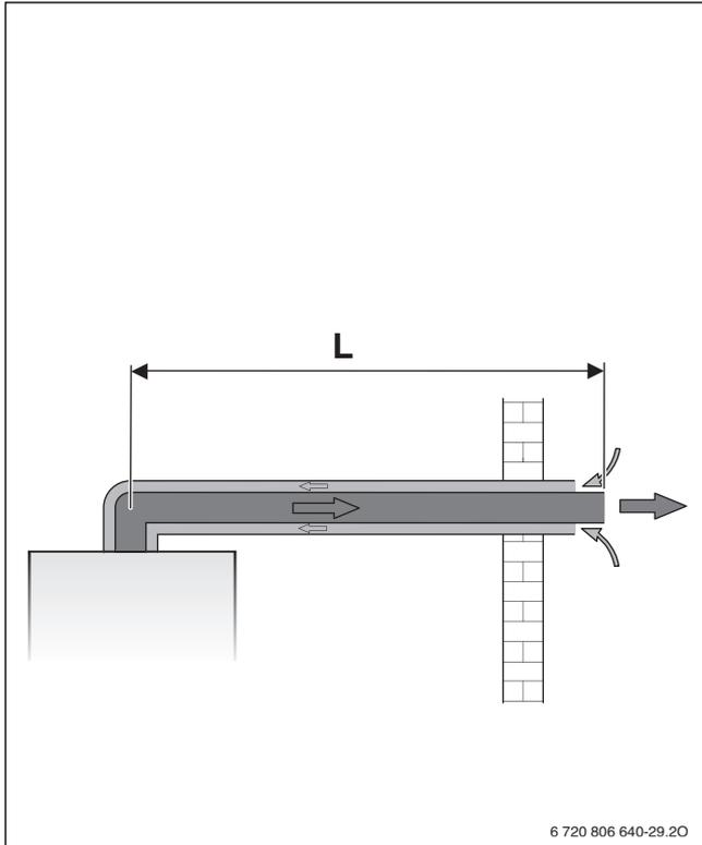
Рис. 8 Горизонтальный отвод дымовых газов с концентрической трубой C<sub>12</sub>
