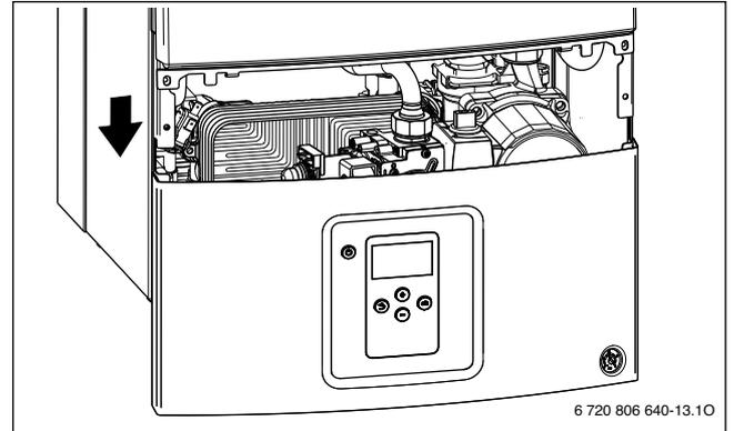
Рис. 30 Подвешенный на раме блок управления для одновременной работы с газовой арматурой
