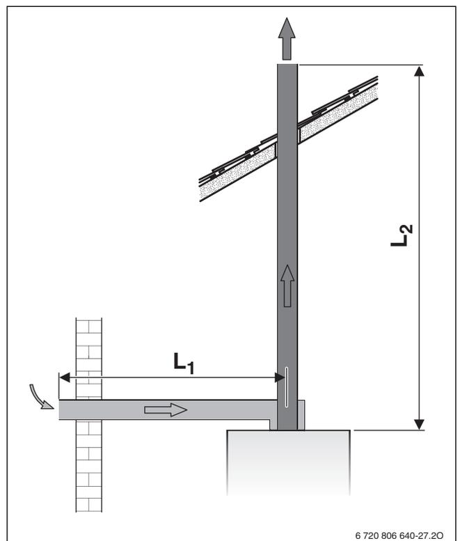
Рис. 12 Вертикальный отвод дымовых газов через отдельную трубу C<sub>52</sub>
