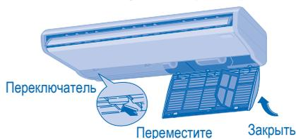
1. Установите воздушные фильтры в распределительную решетку на входе воздуха, выполняя действия их снятия в обратном порядке.
