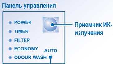
**Кнопка ВЫКЛ./ВКЛ. автоматического режима**
